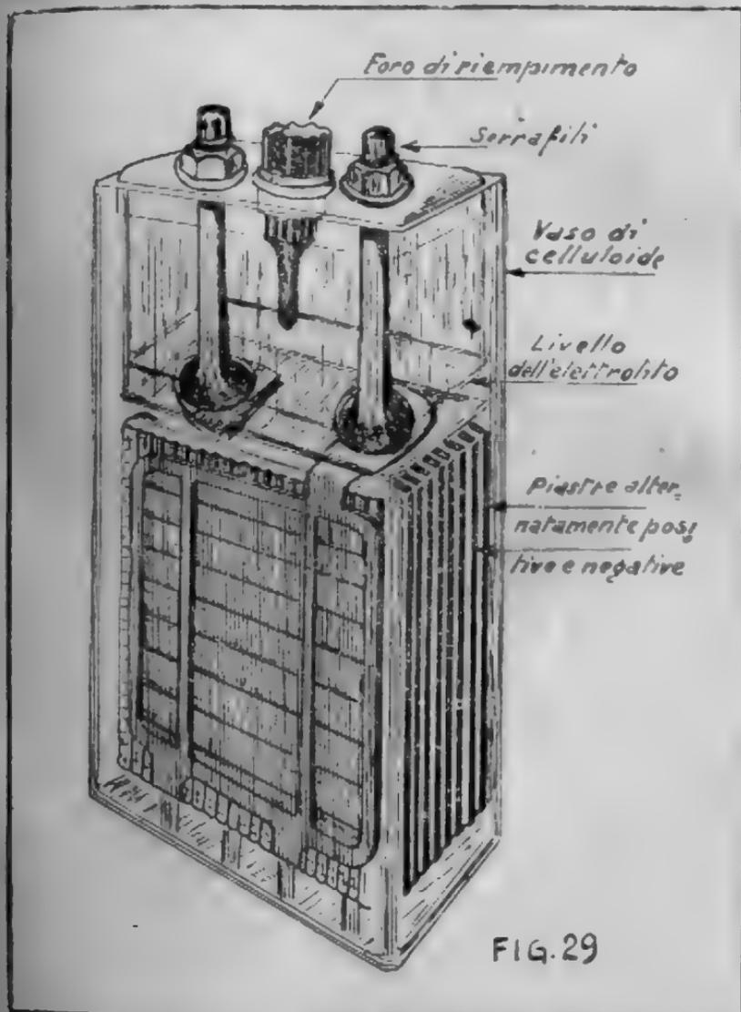
danno ad esse l'aspetto di griglie. Fra le nervature delle piastre
