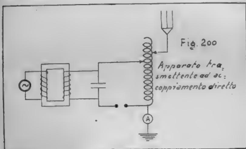
Tenuto conto che le oscillazioni d'antenna sono debolmente smorzate, a parità di potenza in giuoco sull'antenna, si hanno valori istantanei della tensione meno elevati, di quando le oscillazioni d'antenna sono a forte decremento. Di conseguenza gli isolatori dell'antenna sono meno cimentati.
