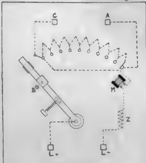
Reostato di avviamento con due serrafili di linea
