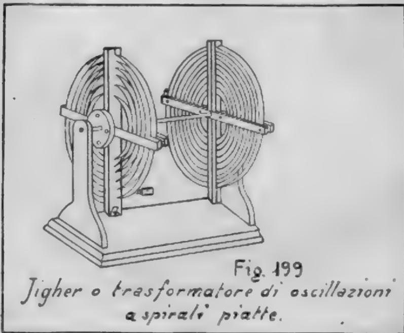
coppiato all'aereo o induttivamente o direttamente, come in Fig. 195 o 200, la sua resistenza non si somma a quella dell'antenna. Di conseguenza il decremento delle onde irradiate è moderato. Il condensatore del circuito oscillante chiuso può avere una capacità elevata; per tal fatto esso accumula una grande quantità di energia, e, se si usa uno spinterometro ad elettrodi fissi, la scarica del condensatore dura per un tempo
