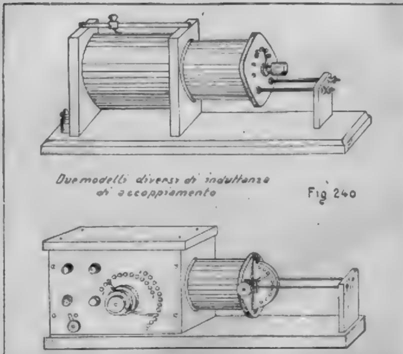
quando quella di accoppiamento non è sufficiente per la lunghezza d'onda in arrivo. Le ordinarie induttanze d'aereo e quelle di accoppiamento sono generalmente ad un unico strato di spire; sono alte da 12 a 20 cm ed hanno da 8 a 12 cm di diametro, mentre le induttanze d'aereo per onde lunghe hanno talvolta un'altezza di 50 cm o più. L'induttanza delle prime oscilla fra 1000 e 5000 microhenry, mentre quella delle seconde si aggira
