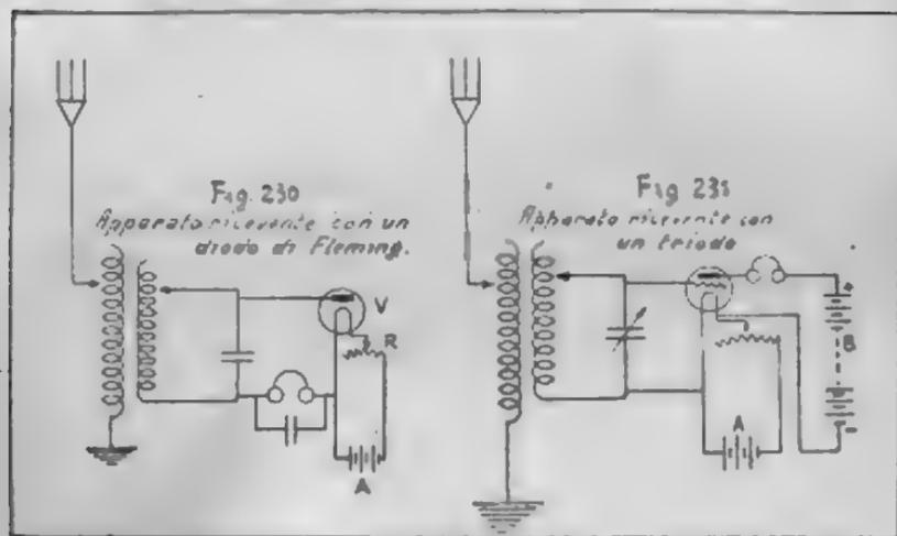
vece di due. I circuiti del filamento e dell'elettrodo più vicino a questo sono esattamente gli stessi che in Fig. 230. Però il telefono è inserito in un circuito contenente la batteria di accumulatori B, e con questo mezzo l'intensità dei segnali ricevuti è maggiore che con lo schema precedente. (Per la teoria del funzionamento del triodo come raddrizzatore, vedi cap. seguente par. 191).
