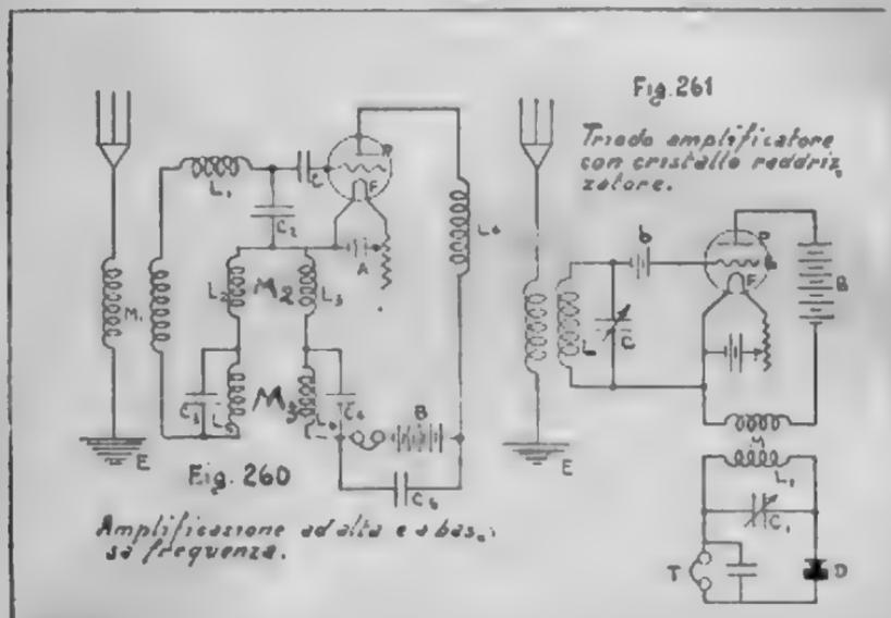
tensione di griglia più opportuna, per ottenere il funzionamento di un triodo amplificatore, non coincide con quella che dà luogo al miglior effetto raddrizzante; sarebbe questa una ragione per assegnare le due funzioni a due distinti triodi. Con questo sistema però l'apparato ricevitore perde in semplicità; e perciò da taluni si preferisce la combinazione di un triodo amplificatore con un cristallo raddrizzatore, come indica la Fig. 261.
