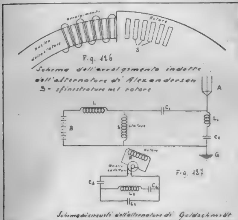
Senza pretendere di darne la dimostrazione, accettiamo come fatto sperimentale, che, se in un rotore in moto si inviano correnti alternate, aventi la frequenza di sincronismo (ossia la frequenza, che si genererebbe nel rotore, qualora la macchina funzionasse da generatore), si manifestano nell'intensità del
