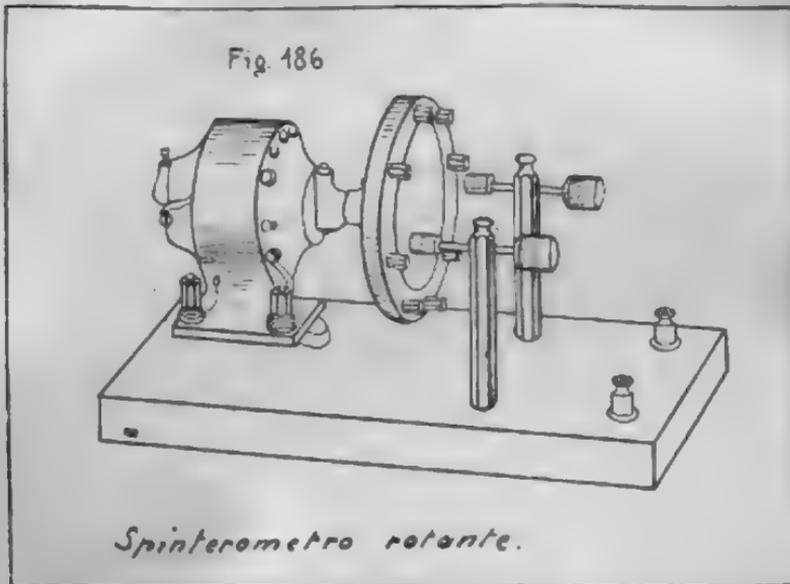
nn altro tipo di spinterometro rotante). Uno dei vantaggi dello spinterometro rotante è di impedire la formazione dell'arco, per effetto del suo movimento, della ventilazione che produce, e perchè gli elettrodi, che si presentano successivamente agli spazi spinterometrici, hanno tempo di raffreddarsi negli intervalli di pausa.
