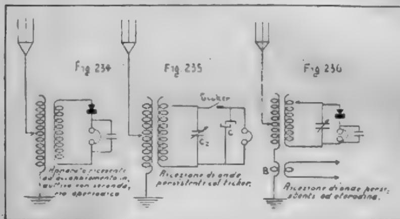
effettua colla semplice manovra di un commutatore. Si esclude il secondario, ed il telefono si deriva ai capi del raddrizzatore invece che sul condensatore di capacità invariabile  $FC$ . Adottando un valore medio di accoppiamento, non occorre di solito variarne la regolazione: perciò le operazioni necessarie per sintonizzare l'apparecchio si riducono alla regolazione della sola induttanza  $L_1$ .
