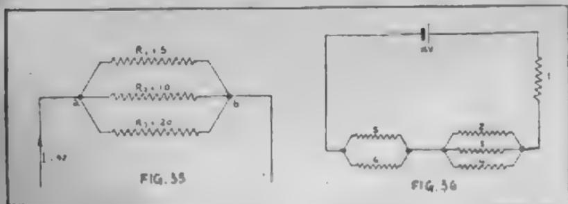
Quando delle resistenze sono connesse in parallelo, la caduta di tensione fra  $a$  e  $b$ , Fig. 34, è costante, e la corrente totale si suddivide fra le varie derivazioni. (1)
