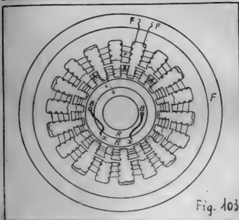
Fig. 103. — Alternatore ad armatura rotante. A. armatura; F. guscio; P. poli; R. anelli collettori; B. spazzole; FF, terminali del circuito d'eccitazione; XX, conduttori al circuito esterno.
