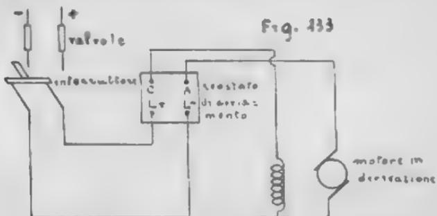
Connessioni fra un motore in derivazione
