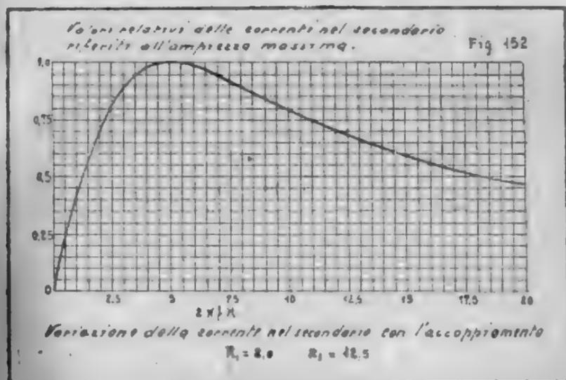
122. **Oscillazioni libere nei circuiti accoppiati, a piccolo smorzamento.** — Supponiamo di dare in un certo istante al condensatore del circuito primario una determinata carica, e di chiudere il circuito primario o direttamente, o attraverso uno spazio spinterometrico. Se il circuito secondario è aperto, il primario oscillerà liberamente, la frequenza della corrente sarà data
