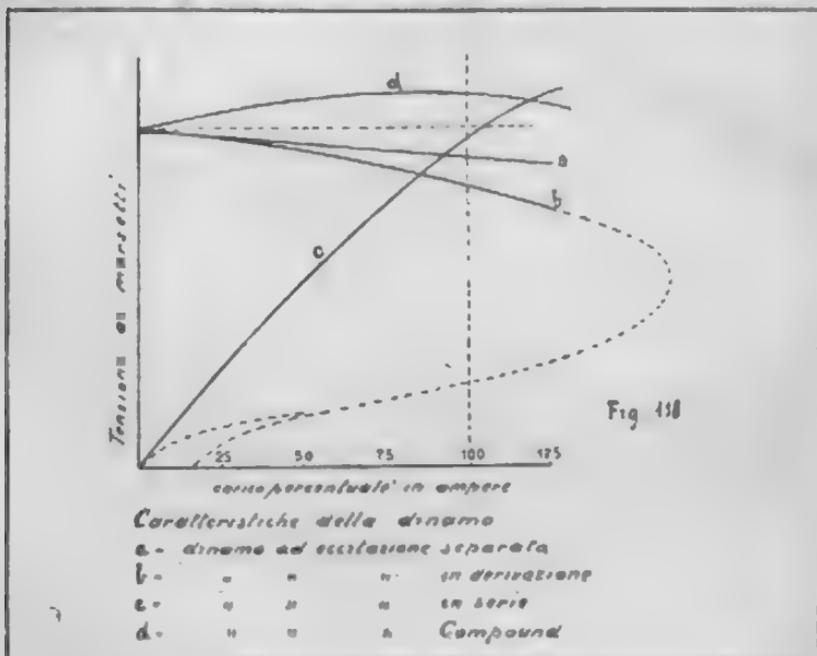
un'eccitazione in derivazione da una in serie, giova osservare le connessioni fra le bobine dei diversi poli. Se l'eccitazione è in derivazione, i conduttori di collegamento sono di piccola sezione, perchè devono portare solo una debole corrente; se l'eccitazione è in serie i conduttori sono grossi, e nelle dinamo di maggior potenza sono addirittura delle sbarre o larghe strisce di rame.
