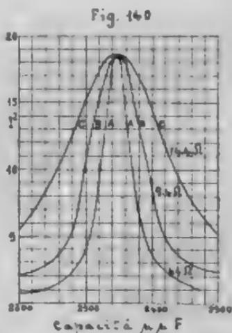
Effetto della resistenza sulla forma delle curve di risonanza.
