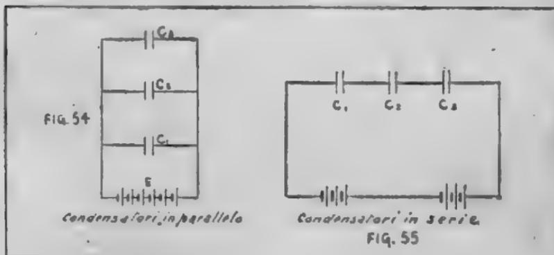
ficie delle armature. Riunire i condensatori in parallelo equivale semplicemente ad aumentare l'area delle armature. Se con  $C_1, C_2, C_3,$  ecc. indichiamo rispettivamente le singole capacità dei vari condensatori, e  $C$  rappresenta la capacità equivalente dell'intero gruppo, possiamo scrivere
