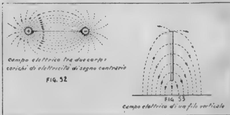
torno al sistema sarà quello della Fig. 53, che rappresenta il campo elettrico prodotto da un'antenna radiotelegrafica.
