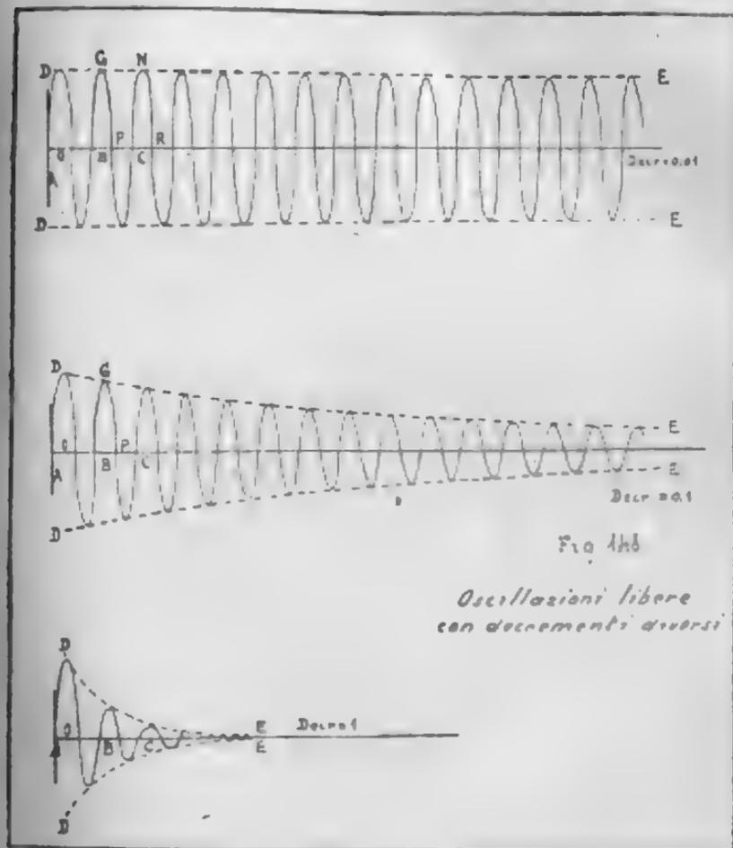
ragione di quello, che avviene nel circuito di scarica, a partire dal momento, in cui vi è inserito il condensatore, le cui armature siano state portate ad una certa differenza di potenziale. Quando il condensatore comincia a scaricarsi, dà luogo nel cir-
