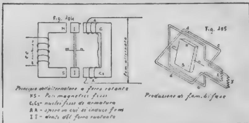
« alternatore a ferro rotante », e si usa per generare correnti ad alta frequenza fino a circa 100.000 periodi al secondo. Il principio di funzionamento di queste macchine è indicato in forma schematica in fig. 104. Sia il campo magnetico che l'armatura sono fissi; fra
