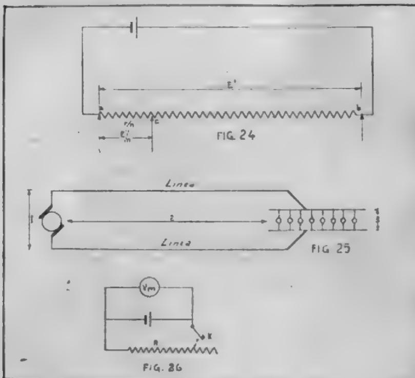
zionale alla resistenza  $r$ , per avere un valore di tensione che sia  $\frac{1}{n} E'$ , basta porre il contatto  $C$  in un punto tale che la resistenza  $ac$  sia eguale a  $\frac{1}{n} r$ . Questo deriva dall'equazione (10), dalla quale si vede che la fem. attraverso una resistenza qualunque è direttamente proporzionale a questa resistenza, fintan-
