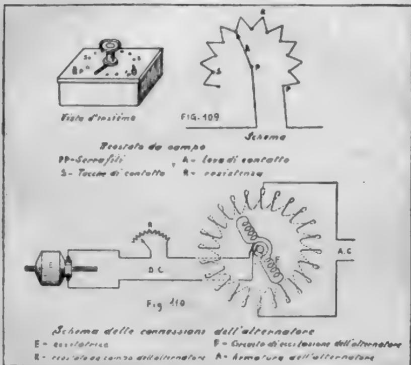
il reostato di campo *R*, fra l'eccitatrice *E* e il circuito di eccitazione *F* di un alternatore a induttori rotanti.
