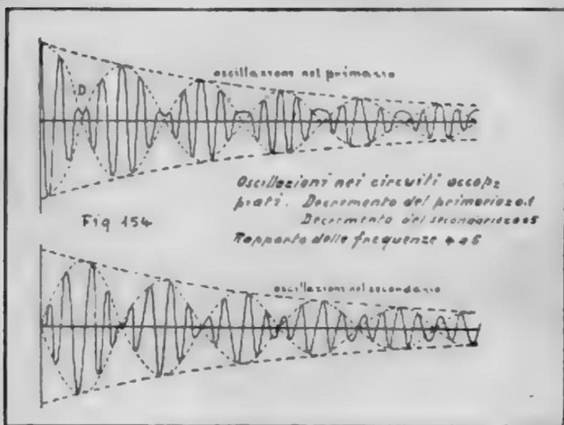
corrente nel secondario è nulla e viceversa. Inoltre, in corrispondenza ad ampie oscillazioni del primario, si hanno deboli oscillazioni nel secondario e viceversa, etc.
